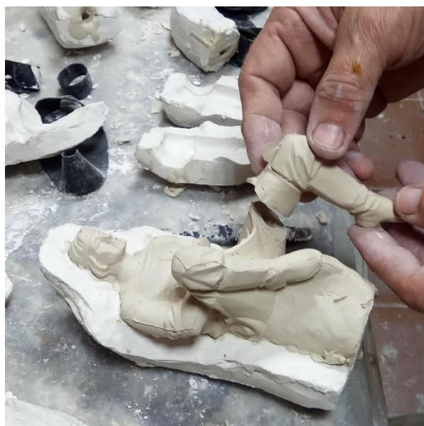
Изделие на последнем куске формы и первая деталь для приклеивания
