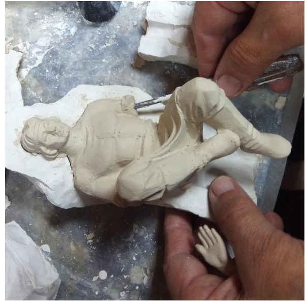
Подготовка изделия к приклеиванию «левой руки» после обработки швов детали
